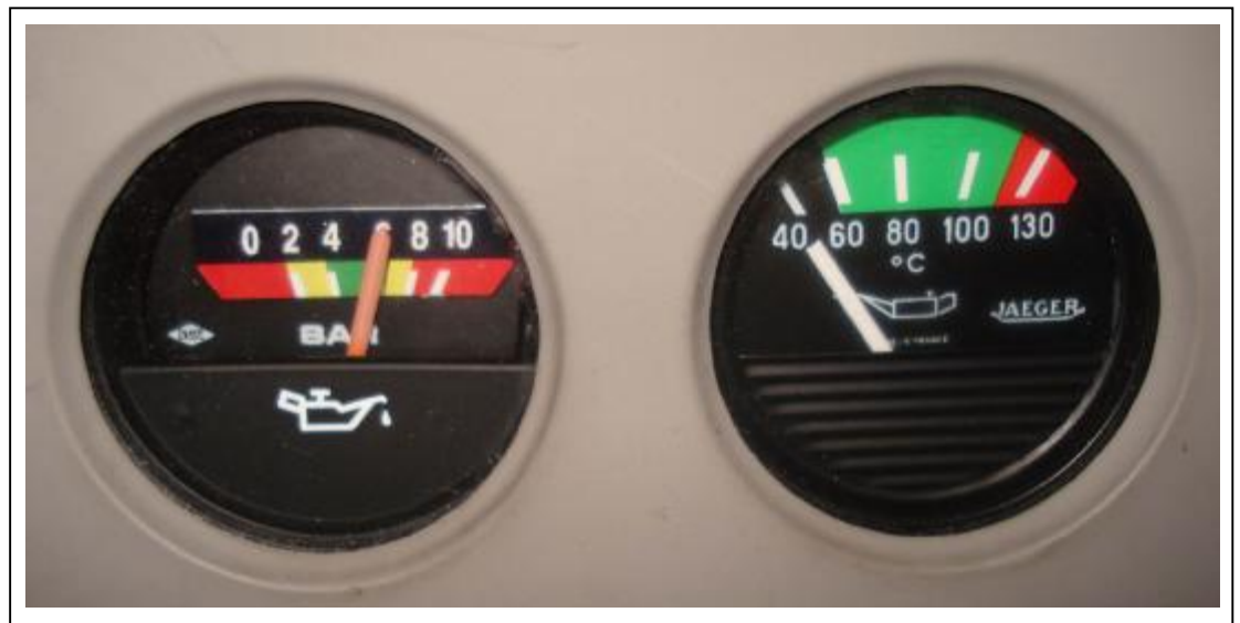
Indicateurs de pression d'huile ( à gauche ) et de température ( à droite )
